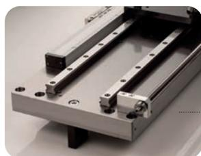
La linearità di movimento è garantita sull'asse X da 2 guide mentre sull'asse Z da 1 guida lineare a ricircolo di sfere con pattini precaricati a 4 punti di contatto. Le guide sono fissate direttamente al basamento del presetter per garantire una perfetta linearità e geometria della struttura. Entrambi gli assi sono dotati di righe ottiche con risoluzione millesimale (0,001 mm) e viene fornito il certificato di collaudo.
