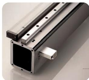
**ASSE Z:** Colonna sovradimensionata, in acciaio, termicamente stabilizzata. Guida con classe di precisione SP e pattino precaricato con ricircolo di sfere. La linearità di movimento è garantita da **1 guida a ricircolo di sfere** con pattini precaricati a 4 punti di contatto. L'asse è dotato di righe ottiche con **risoluzione millesimale (0,001 mm)** e viene fornito il certificato di collaudo.
