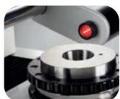
La **telecamera** è una C-MOS ad alta risoluzione con lenti telecentriche. Offre un **campo di visione di 7x7 mm** in modalità real view e profile view ed un ingrandimento digitale fino a 40x.
