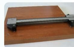
**CALIBRO PER MISURE LINEARI ED INTERASSI DI FORATURA**
