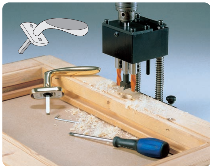
Foratura di finestre in legno e PVC per inserire la scatola cremonese Drilling of wood and PVC window frames to fit cremone bolts
